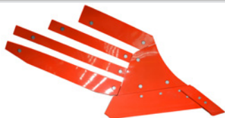
MP4C - Versoio a stecche, cilindrico, ideale per suoli sabbiosi/limosi. (Profondità di lavorazione 25 – 40 cm).
