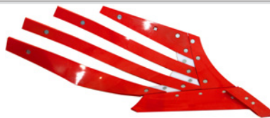
MP4N - Versoio a stecche, semi elicoidale, ideale per suoli pesanti/umidi. (Profondità di lavorazione 20 – 30 cm).
