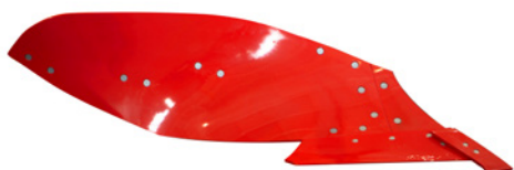
MP4WD - Versoio pieno, semi elicoidale, ideale in suoli pesanti/umidi per trattori con ruote larghe ( \leq 800 mm). (Profondità di lavorazione 15 – 30 cm).
