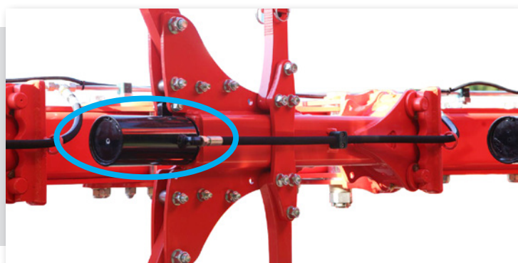
1° e 4° corpo con alesaggio maggiorato del cilindro.
