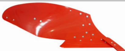
MP4WN - Versoio pieno, semi elicoidale, ideale per suoli pesanti/umidi. (Profondità di lavorazione 20 – 30 cm).
